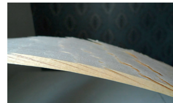
Figur 3.6. Böjer man spånerna visas ”fjällen”. Fjällen skall vändas nedåt likt medhårs på en päls. Vänds de fel blir fjällen som öppna fickor för vatten och polleninträning samt förhindrar upptorkning.
