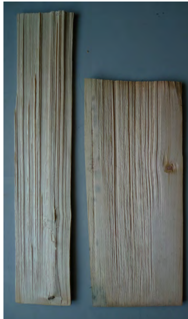
Figur 4.1. Gran- och furuspån. Kännetecken på gran är de små pärklvistar mellan grenvarven och att det inte är någon skillnad på färgen mellan splint- och kärnved. Furu känns lättast igen om det går att se färgskillnaden mellan den rödaktiga kärnveden och den gulvita splintveden.
