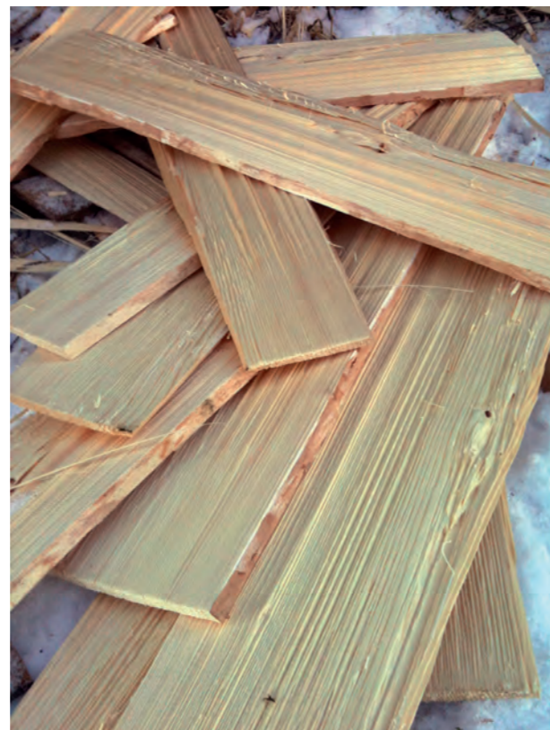
Figur 2.7. Hyvlade stickspån med raka fibrer där hyveln spräckt isär spånen.
